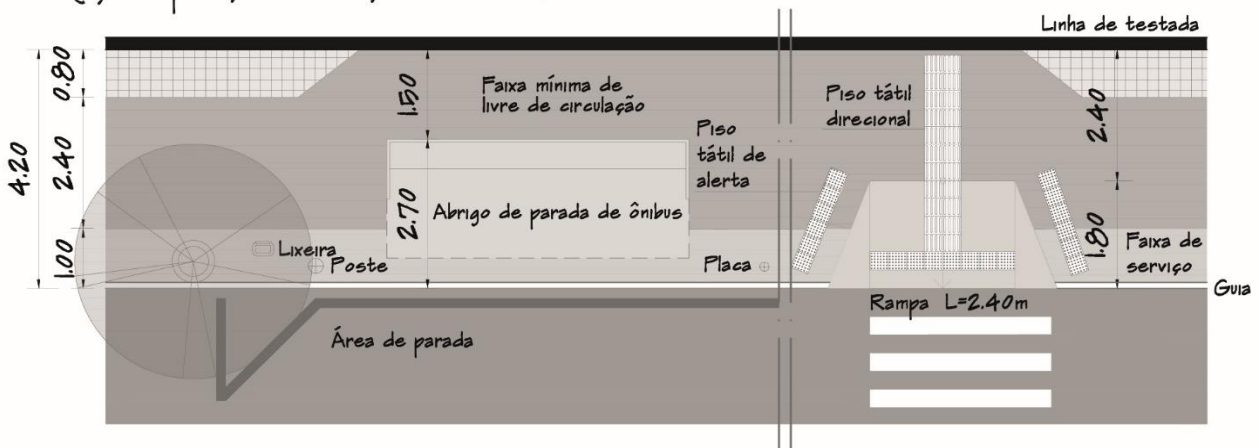
(ii) composição de calçada em via Coletora
